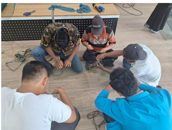
Gambar 2. Proses perangkaian sampai menjadi satu alat tangkap bubu
