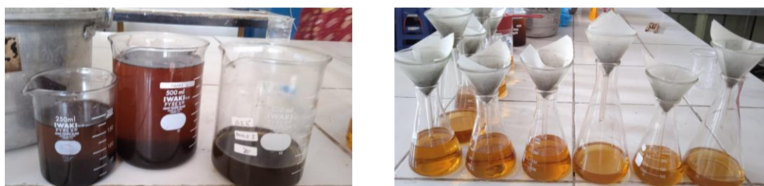
Gambar 1. Proses Perendaman Minyak Jelatah dengan Arang dan Penyaringan
